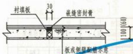
钢筋混凝土内衬底板、侧壁变形缝
